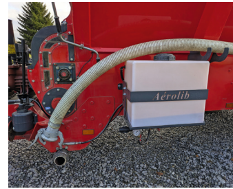
Le système Aerolib validé par Samuel Ollivier permet de réduire la poussière dans le bâtiment par injection d'eau à la sortie de la pailleuse. ©M. Portier
