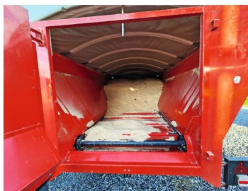
La caisse est dotée d'un fond mouvant robuste. La porte arrière facilite l'accès pour l'entretien et donne la possibilité de la vidanger.
