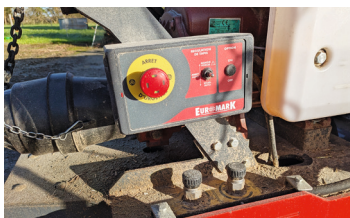
Les deux seuls réglages de la pailleuse concernent la vitesse des moteurs hydrauliques entraînant le fond mouvant et l'écluse rotative.
