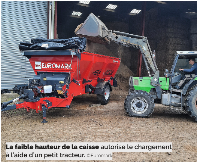
La caisse est dotée d'un fond mouvant robuste. La porte arrière facilite l'accès pour l'entretien et donne la possibilité de la vidanger.
