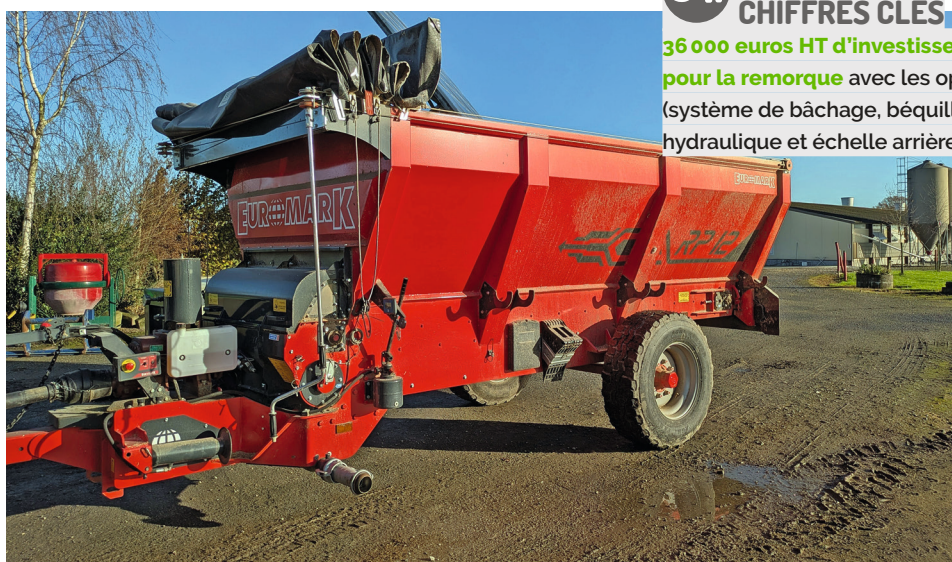
La pailleuse pneumatique Euromark RP12 dispose d'une caisse de 12 m 3 qui peut accueillir tout type de litière en vrac (paille broyée, copeaux, sciure...). ©M. Portier
